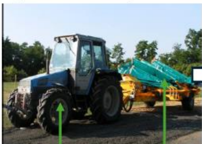
Remorque avec corolle 2 m de large et bac Le bras de la corolle se met au niveau de l'arbre
