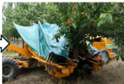
La corolle agrippe l'arbre et l'englobe avec une bâche de 3m de rayon
