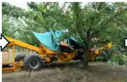
Remorque avec corolle 2 m de large et bac Le bras de la corolle se met au niveau de l'arbre
